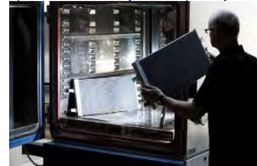
Testy starzeniowe, środowiskowe, cykle ciśnieniowe, odporność na niskie i wysokie temperatury
