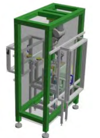
Przykład specjalnego stanowiska wykonanego w celu zautomatyzowania gniazda linii produkcyjnej
